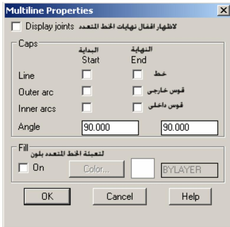
و بعد عمل التعديلات المختلفة نقوم بالضغط على الزر Add لاضافة النمط الجديد و اذا اردنا الاختيار بين الانماط المختلفة للخطوط المتعددة نضغط على السهم الصغير المجاور ل Current لتظهر الينا الانماط المختلفة و نقوم باختيارها بالضغط عليها ثم نضغط على الزر OK لتنشيط هذا النمط و جعله هو الاختيار الحالي .
